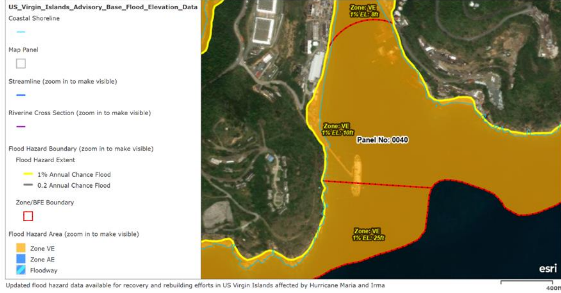
Figura 5. Mapa de recursos de peligro de inundación de las Islas Vírgenes de EE. UU., Zona de inundación de FEMA VE 1% EL: 10 pies se encuentra dentro de la propiedad VIWAPA que contiene la infraestructura de GLP.
